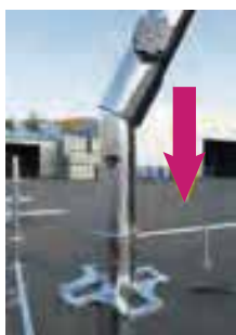
●組立時 差し込むだけでロック状態
